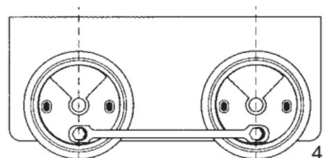
**ACHTUNG!** Achten Sie beim Auswechseln der Radsätze darauf, daß die Kuppelstangen nicht klemmen (Abb. 4). Wenn sich die Kuppelstangen nicht frei drehen lassen, kann dies zu schweren Schäden am Modell führen.
